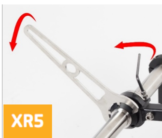
Afbeelding nr. 39 De conische moeren en inbusbout losdraaien
