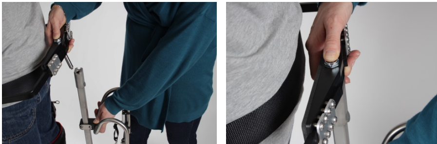
Afbeeldingnr. 24 Het verbinden van de beugel met het onderstel
