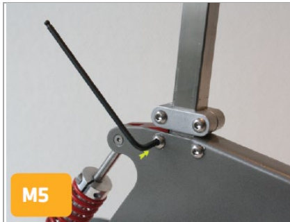
Afbeeldingnr. 46 Moeren aan beiden kanten aandraaien
